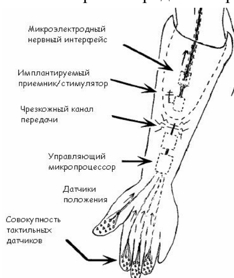
рис.5. Структура протеза с естественной чувствительностью
